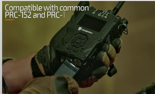
Rf Patrol es un dispositivo de detección de UAS portátil, altamente versátil, completamente pasivo/sin emisiones . El dispositivo ofrece al usuario un conocimiento real de la situación sin distracciones ni operaciones complejas. Ha sido diseñado para ser altamente efectivo para una variedad de operadores en una variedad de entornos exigentes. El dispositivo Rf **Patrol** detecta automáticamente drones que se mueven a cualquier velocidad.
